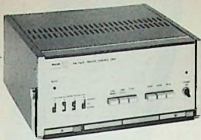
Afb. 7 In grotere automatische testinstallaties vormt de drucker-stuureenheid, PM 2465, het „zenuwcentrum“.
